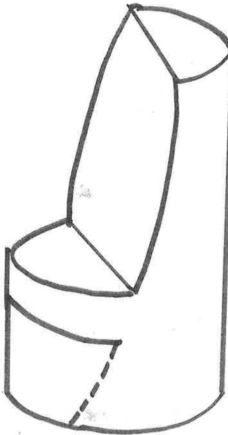
④ 電源用の溝を切り取る。
